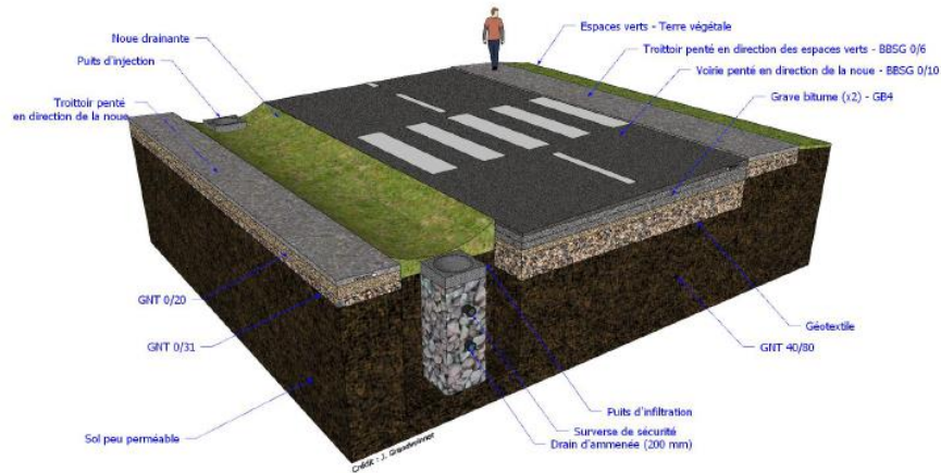
Figure 31 : Bloc diagramme d'une noue drainante conjuguée à une voirie pentée - ECR Environnement
